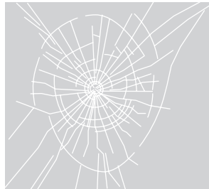
<合わせガラスが割れた状態>
