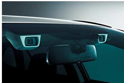
「世の中の交通事故をゼロにしたい」というエンジニアの強い想いから独自のアプローチで生まれたアイサイトは、ステレオカメラのみで自動車、歩行者、二輪車を検知し、車両の前方衝突の回避または衝突被害の軽減を図ることに加え、全車速追従機能付きクルーズコントロールや車線認識によるレーンキープ機能など、様々な予防安全機能を実現。予防安全性能アセスメント<sup>\*1</sup>でもアイサイトを搭載するすべてのモデルで最高ランクを獲得するなど、世界トップレベルの運転支援システムとして高い評価をいただいています。
