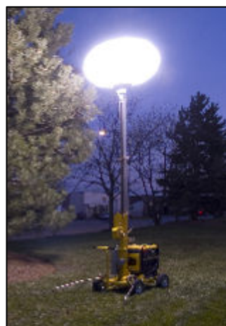
発電機と投光機
