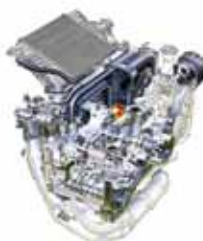
欧州仕様水平対向 4気筒 2.5 ターボエンジン
