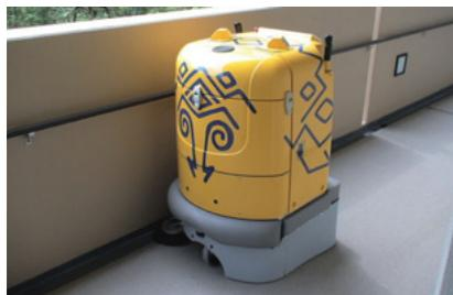
PHOTO:都内のマンションで稼働する屋外型清掃ロボット。
