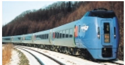
JR北海道に納入した「振り子式特急気動車 キハ283」札幌・釧路間をスーパー大空として運行中
