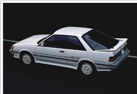
スバル初のフルタイム4WDを搭載した、レオーネ3ドアクーペRX-II(1986年)
