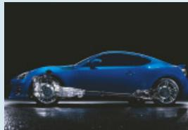
スバルの水平対向エンジンを持つ「低重心」「軽量」「コンパクト」という特長を最大限に活かすため、より低く、より車両中心に近い位置にエンジンを搭載した専用のプラットフォームを開発しました。また、超低重心でありながら、日常的な使用に不足しない最低地上高(ロードクリアランス)を確保しております。
