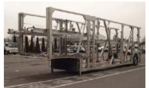
さらに軽量化と防錆を向上させたアルミ・カーリアトレーラ「TS1050A1R」
