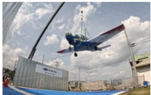
自動車衝突試験用ダミー人形を用いた全機落下試験
