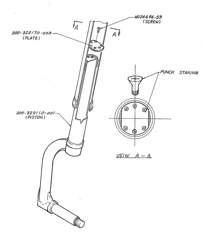
FIGURE I. ILLUSTRATION OF PUNCH STAKING
