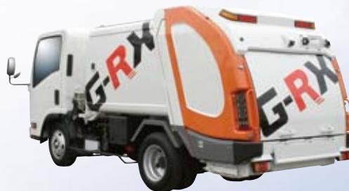
塵芥車のグローバルスタンダードを目指して、当社と新明和工業が共同で次世代型新型回転板式塵芥車「G-RX」を開発しました。無駄な余肉をそぎ落とし軽量化させるとともに、油圧配管の圧損低減、低騒音化、環境負荷物質削減等を図り、従来の塵芥車に比べ環境性能を大幅に向上させています。
