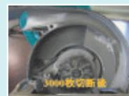
「超硬金属チップ採用ノコ歯」と「ボディ安全カバー部ベアリング化」による耐久性向上
