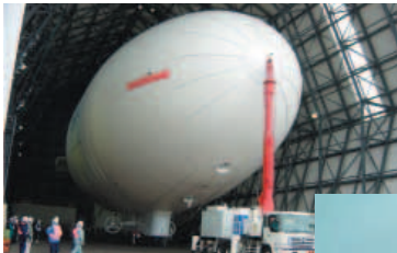
定点滞空試験機を格納庫から出しています (前方のトラックは、マストカーといわれます)
