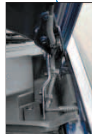
フロントフードのヒンジに衝撃吸収構造を採用
