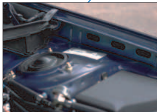
フェンダーの上部に衝撃吸収構造を組み込んでいます。
