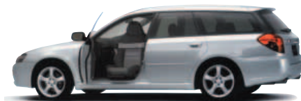
レガシィウイングシート 装備車 レガシィやR2では、室内の居住性を重視し、室内でのシートスライドも電動で行えるようにしました。
