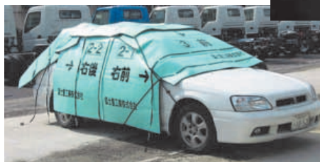
遮音シート取付状態
