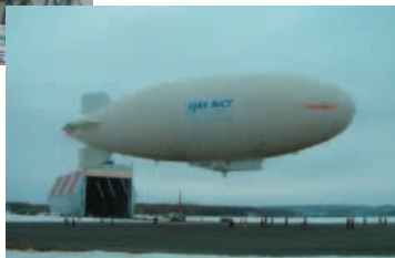
浮上機能確認試験状況
