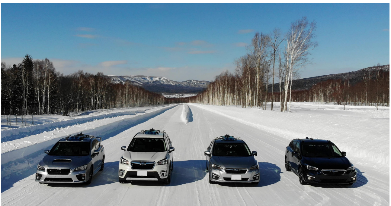
合流試験に使用した 5G および C-V2X システムを搭載した自動運転実験車両と美深試験場テストコース 実験車両は左から WRX S4、フォレスター、インプレッサ SPORT (2台)
