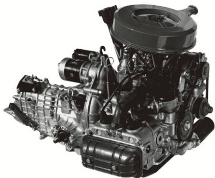
水平対向エンジン EA52 型 (1966年 スバル 1000 に搭載)
