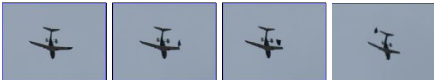
飛行中に主翼の一部が分離しても飛行を継続する様子(写真提供:東京大学)
