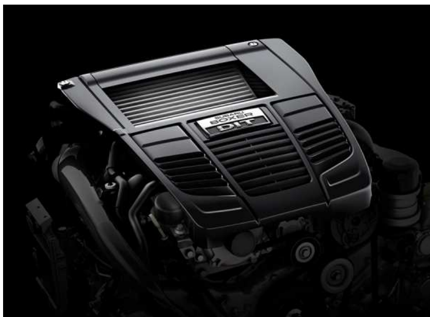
スバル WRX 搭載 「FA20」型水平対向直噴ターボ“DIT”エンジン
